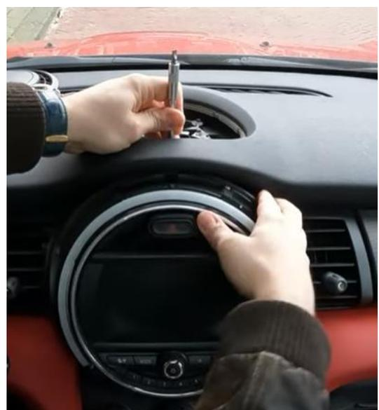
Trennen Sie alle Stecker (5 Stück). Drücken Sie mit einem kleinen Flachsraubendreher auf die Lasche des schwarzen dreipoligen Steckers. Drücken Sie den Videoanschluss auf der Rückseite des Bildschirms unten in die Palette. Hebeln Sie sehr vorsichtig mit einem kleinen flachen Gegenstand zwischen der Naht, wenn der Stecker sehr fest ist. Die restlichen Stecker können durch gleichzeitiges Drücken der Laschen herausgezogen werden.
